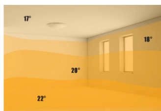
Riscaldamento e raffrescamento con impianto radiante
