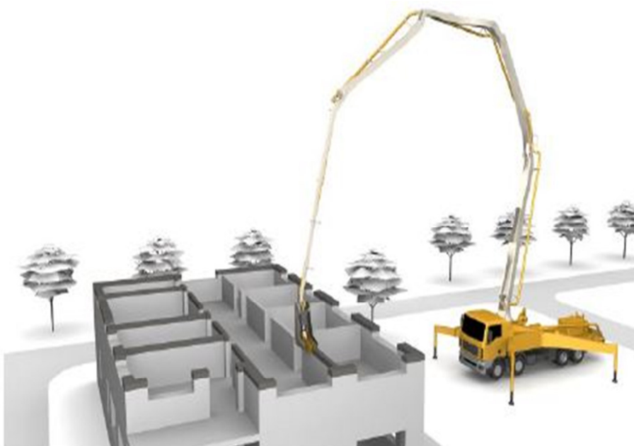
Figura 1: CONPrint3D process (Università Tecnica di Dresden, Iniziativa di ricerca "Future Building"). Research on Build- ing, Urban Affairs and Spatial Development
