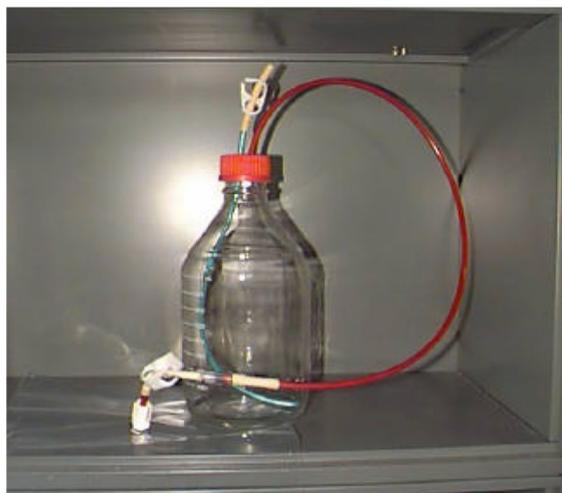
**Fig. 6** - Digestore da 2000 ml utilizzato nello studio di Klasson e Nghiem (2003) [2]
