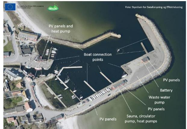
**Fig. 4 -** Panoramica della marina di Ballen (Danimarca) con illustrazione dei componenti della microgrid [27].
