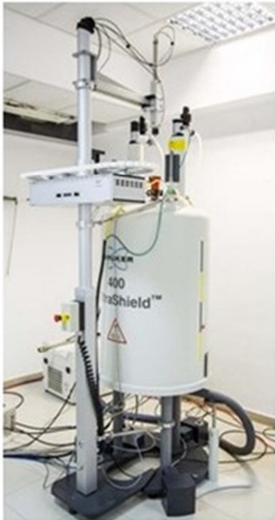
Fig. 1 – Spettrometro NMR Bruker Avance I 400 MHz (Bruker Italia S.r.l., Milano, Italia)
